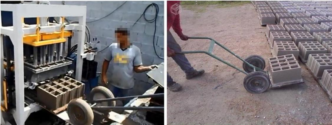
**Figura 1: Carrinho na máquina rebaixada e transportando os blocos**
